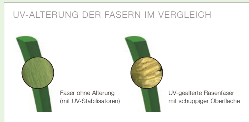
Die UV-Stabilisatoren schützen das Filament vor einem schnellen Alterungsprozess. Das UV-Licht macht die Faser über die Jahre rissig und spröde (rechts).
